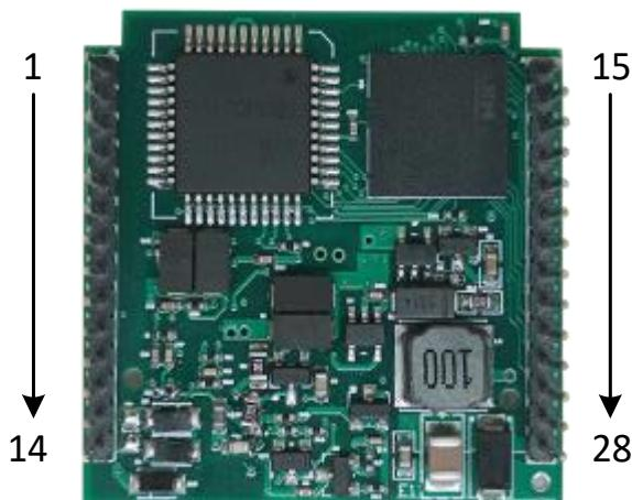
图 2.1 MC0307 Modbus 转 PA 嵌入式核心板模块通信接口定义
