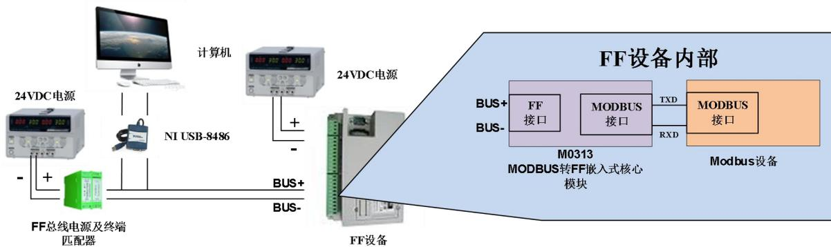
图 3.1 MC0313 Modbus 转 FF 嵌入式核心板模块系统连接图
