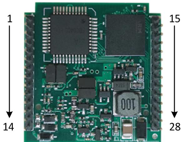
图 2.1 MC0313 Modbus 转 FF 嵌入式核心板模块通信接口定义
