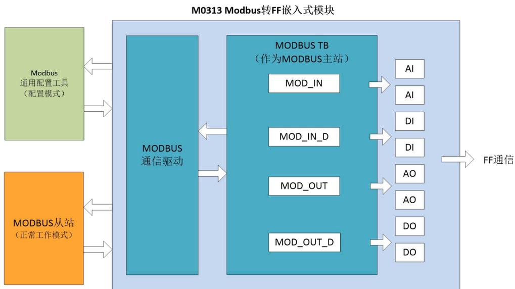
图 3.2 MC0313 Modbus 转 FF 嵌入式核心板模块原理框图
